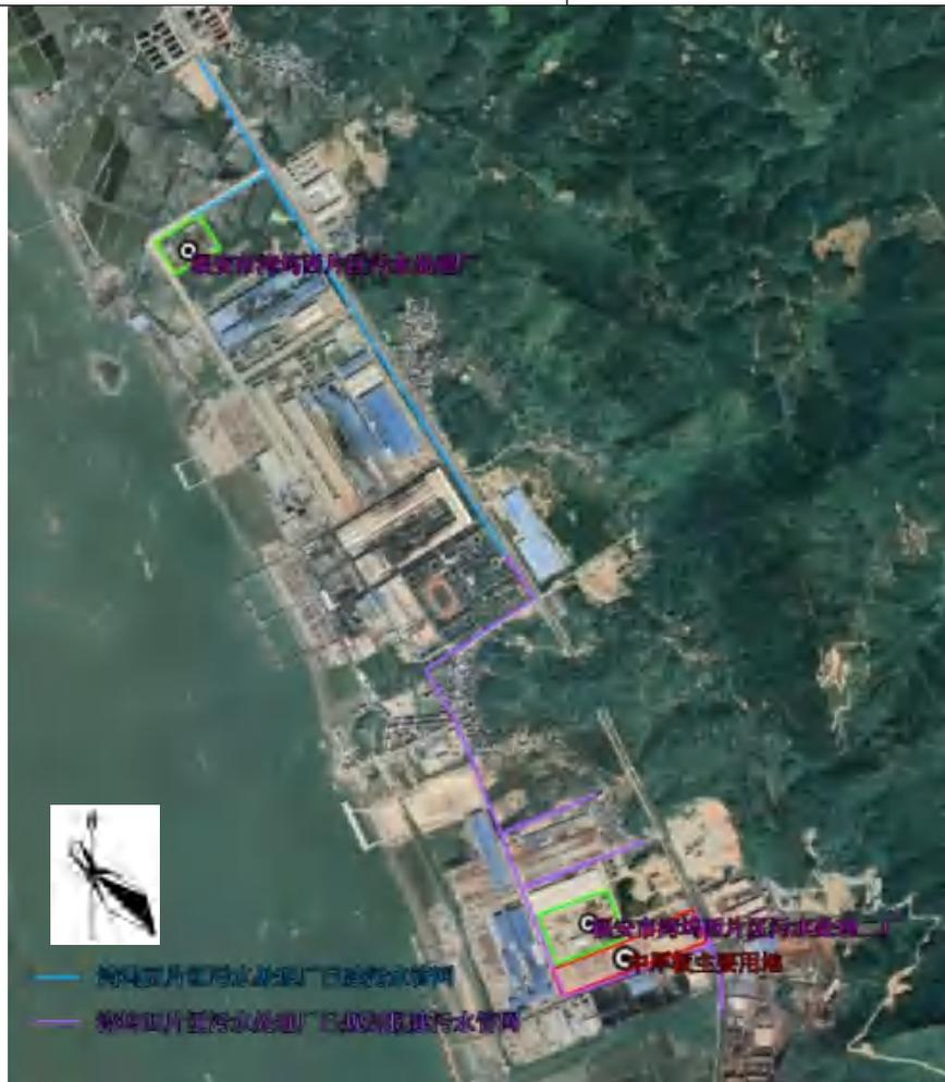
图 2.3-19 湾坞西污水厂污水收集管网走向示意图
